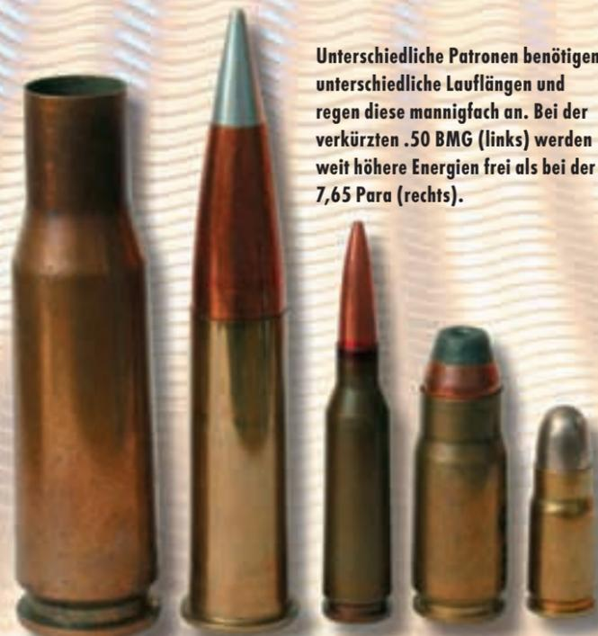
**Unterschiedliche Patronen benötigen unterschiedliche Lauflängen und regen diese mannigfach an. Bei der verkürzten .50 BMG (links) werden weit höhere Energien frei als bei der 7,65 Para (rechts).**
