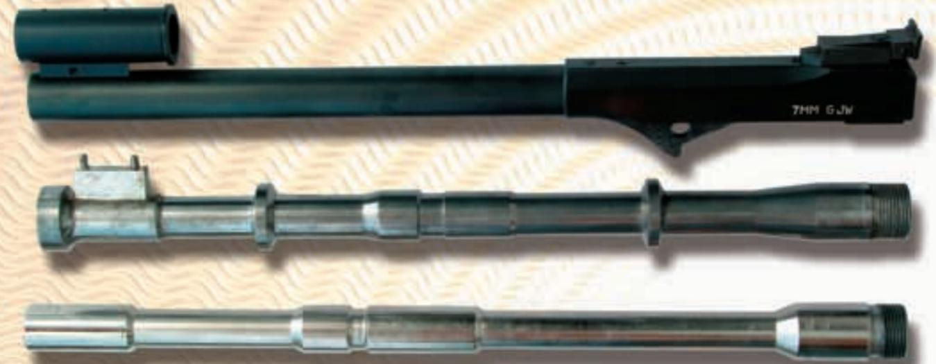
am 30. November 1898 eine aufwändige Untersuchung vor, die sich mit Schwingungen und deren Auswirkung beim Schuss befasste. Sie wiesen Grund- und Obertöne beim Lauf des Gewehres 71 mit Sand auf aufgeklebten Papierstreifen, aber auch schon mit Funkenphotographie nach. Sogar Patronen mit elektrischer Zündung benutzten sie, um die Vibration des Schlagbolzens auszuschalten.
