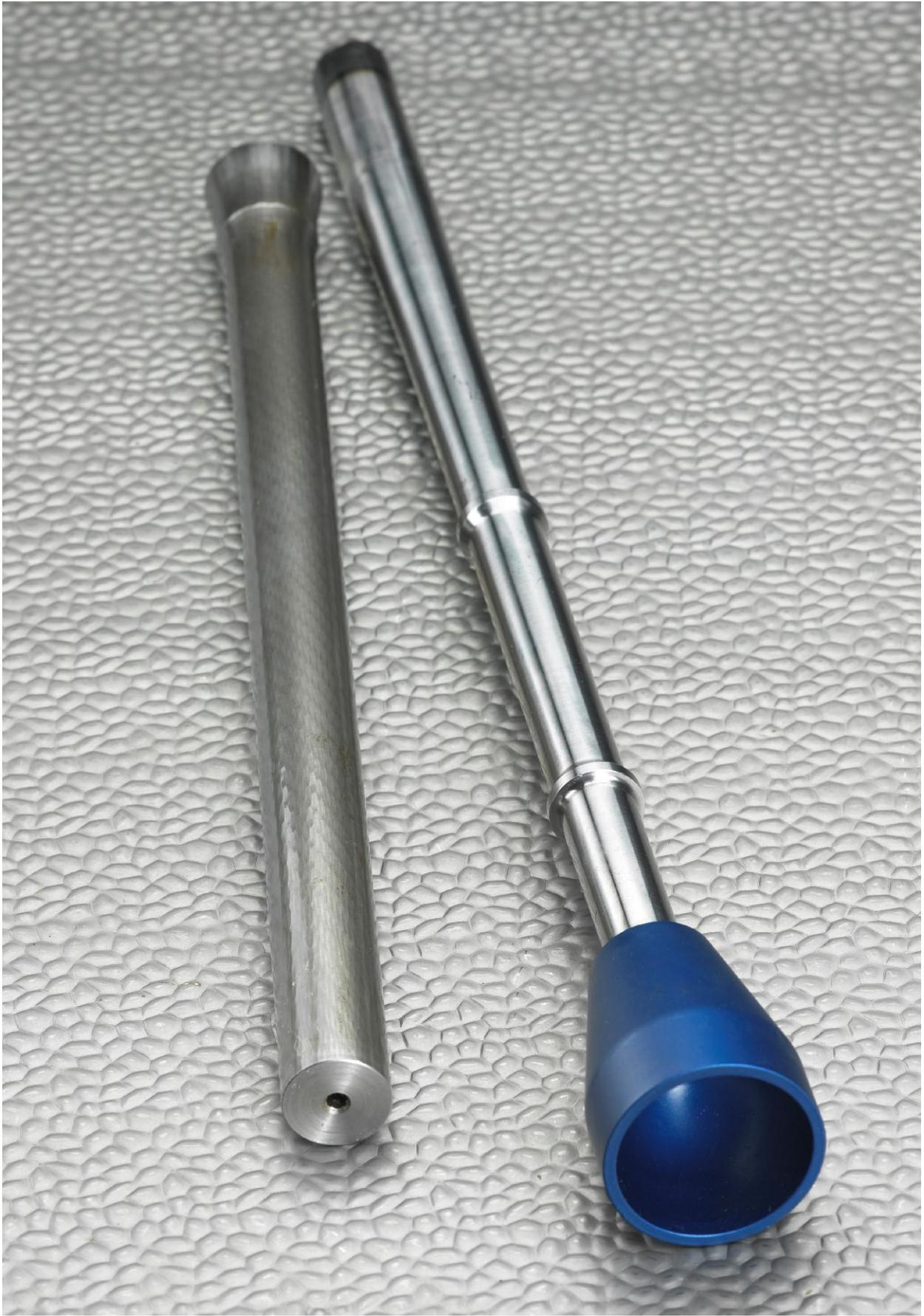
2. Der Lauf eines Gewehr-Prototypen von SIG stellt die momentan höchste Perfektion der Schwingungs-Optimierung dar. Links ein gehämmerter Rohling.
