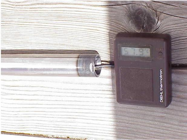
5. Temperaturmessung im Patronenlager eines hell polierten Laufes bei Sonneneinstrahlung.
